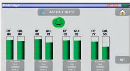
Pointeur satellite avec affichage de la NIT pour assurer un réglage optimal.
