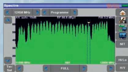
Analyse spectrale rapide avec une fréquence de rafraîchissement de 100 kHz
