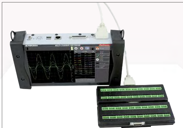
DAS240 équipé de 40 voies de mesure
