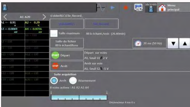
Déclenchement: de multiples possibilités. Une voie, un seuil, plusieurs voies ou plusieurs seuils combinés.
