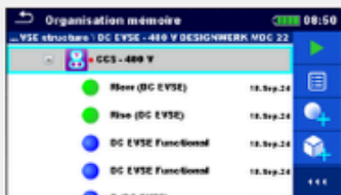
Structure de test dédiée au test des bornes DC
