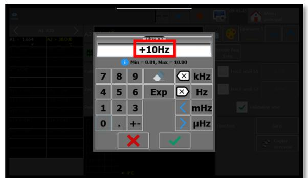
9- Choisissez la période d'acquisition, dans notre exemple nous utiliserons une période d'échantillonnage de « 20ms » chaque voie peut avoir sa propre période d'échantillonnage indépendamment de la fréquence d'échantillonnage de l'enregistreur :
