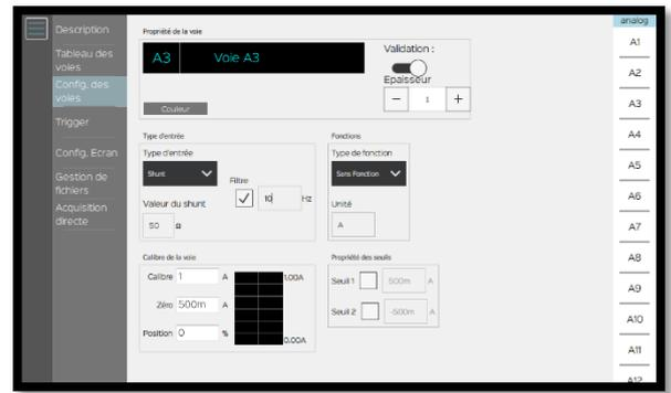
10- La configuration de la voie 3 est alors réalisée, appuyer sur « Envoyer config. ». Nous pouvons ensuite visualiser notre signal :
