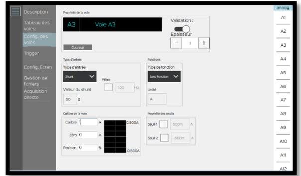
8- Paramétrez le positionnement du 0, ici nous mettrons la valeur 500mA car nous avons un calibre de 1A et voulons visualiser un courant positif. Notre échelle ira donc de 0 à 1A :
