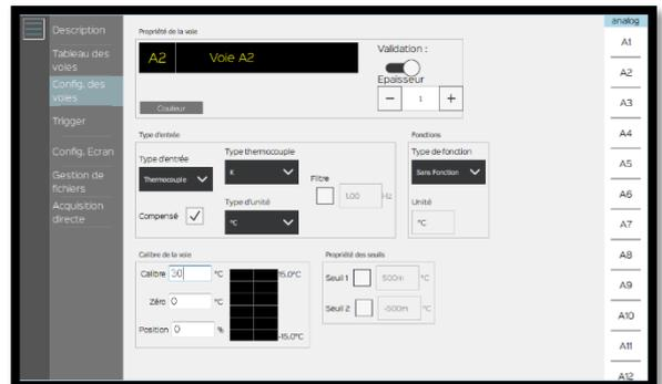
8- Paramétrez le positionnement du 0, ici nous mettrons la valeur 15°C car nous avons un calibre de 30°C et voulons visualiser une température ambiante. Notre échelle ira donc de 0 à 30°C :
