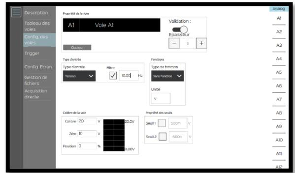
9- La configuration de la voie 1 est alors réalisée, appuyer sur « Envoyer config. ». Nous pouvons ensuite visualiser notre signal :
